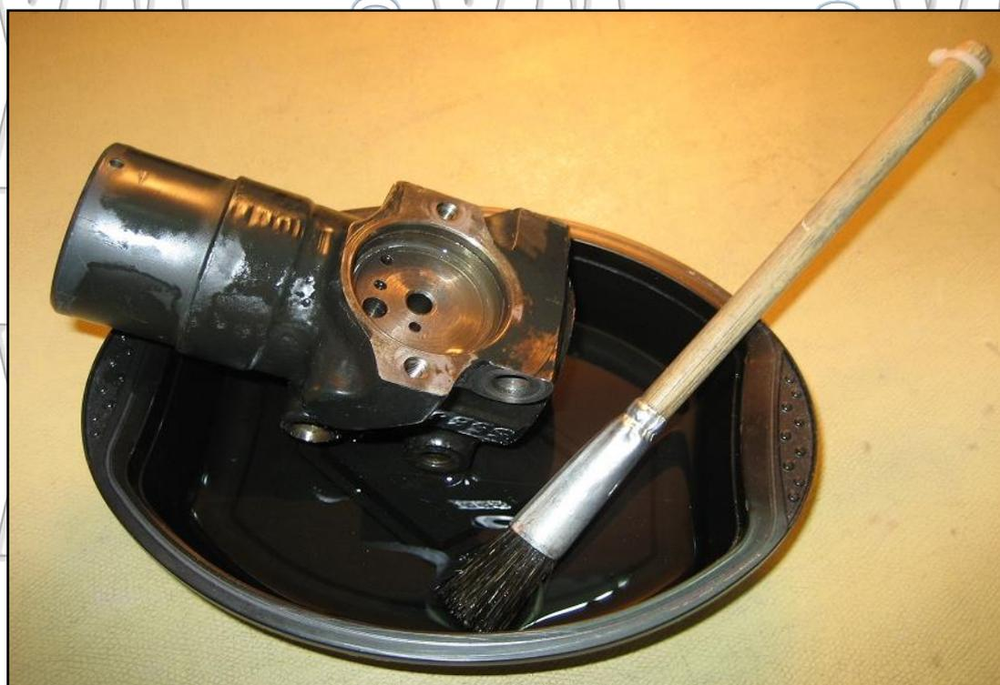
Il faut bien dégraisser TOUS les éléments et ne pas avoir peur de s'attarder sur les multiples conduits internes du corps du conjoncteur-disjoncteur. Avec le temps, un dépôt noirâtre se forme sur les différentes surfaces en contact avec le LHM.
