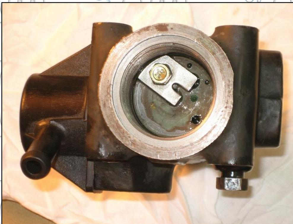
Maintenant il va falloir retirer le bouchon. Il est maintenu par un clip en forme de tore, à l'intérieur d'une gorge.
