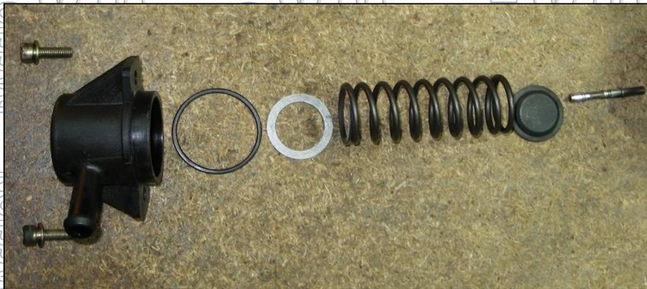
Retirer aussi la vis de dépressurisation (attention à ne pas perdre la bille) et les deux garnitures (joints cylindriques) des tuyaux haute-pression.
